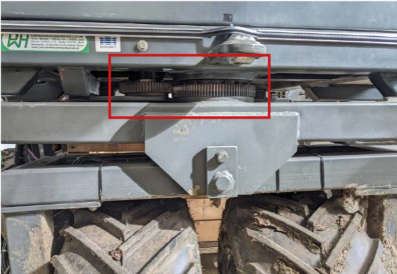
Wichtiges Detail an der Lenkung: Der Multiturn-Drehgeber WV5800M erfasst den Lenkwinkel, damit das Fahrzeug seinen definierten Pfad sicher umsetzen kann.
