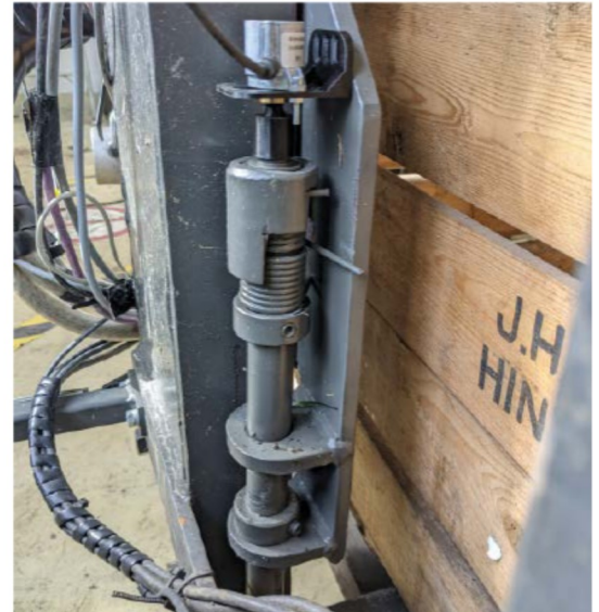
Die Position der Kistenaufnehmer, der sogenannten Flipper, wird über den Miniaturdrehgeber AH255 ermittelt (der Drehgeber befindet sich am oberen Ende der Konstruktion).
